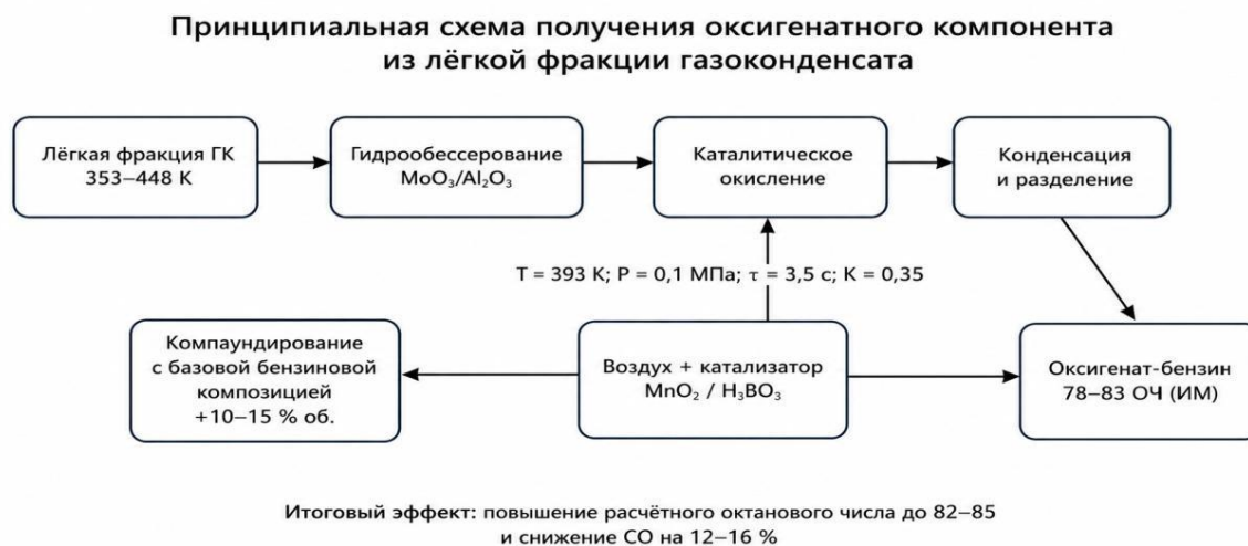
Рисунок 1. Схема получения и применения оксигенат-бензина из лёгкой фракции газоконденсата
