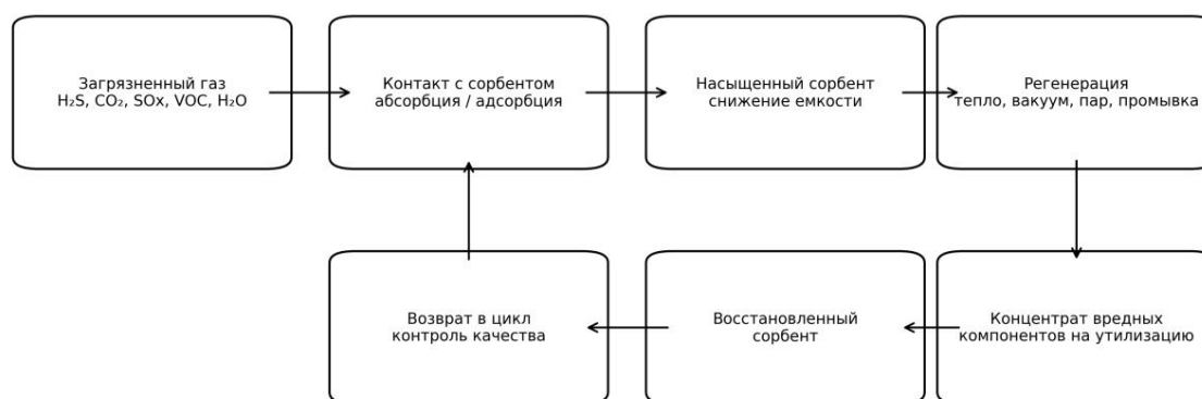
Принципиальная схема замкнутого цикла очистки газа и восстановления сорбента
